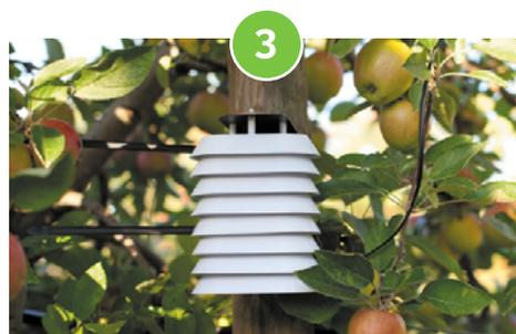
Abri avec capteurs de température et d'hygrométrie
